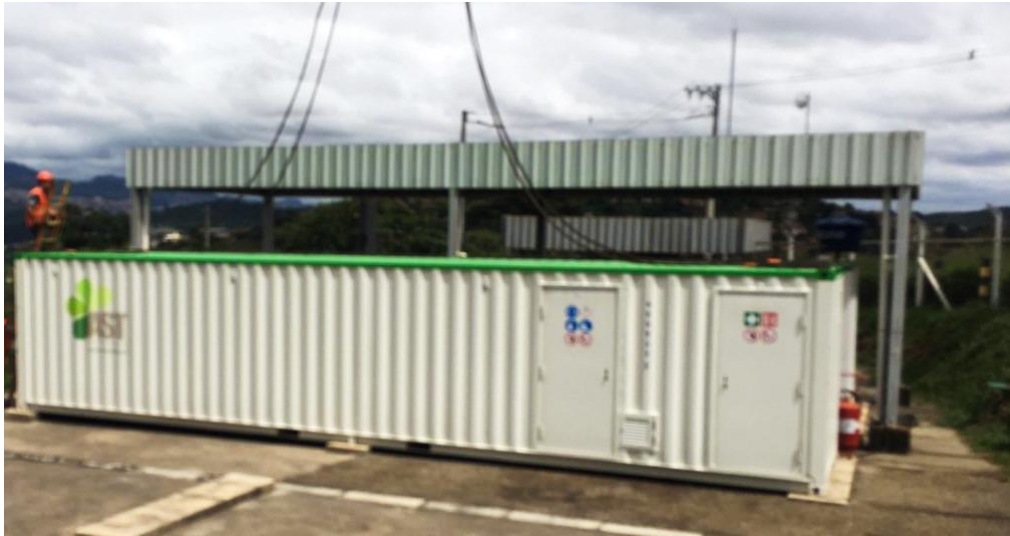
Figura 1: Máquina de tratamento por osmose reversa no local.
